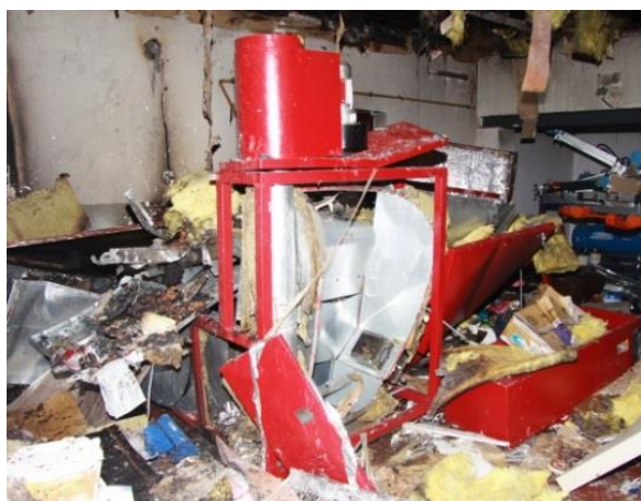
Slika 9: Eksplozija plina v stroju za sušenje majic
