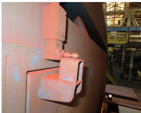
Slika 8: Neustrezno pritrjen vtič na vratih varnostnega stikala
