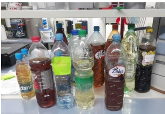
Slika 10: Neustrezno shranjevanje nevarnih snovi
