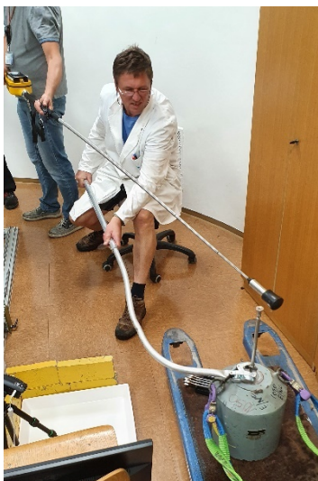
Slika 17: Menjava visoko aktivnega vira ^{137}\text{Cs} z aktivnostjo 355 GBq iz prenosnega vsebnika, vidnega na vozičku, z manipulatorjem na končno pozicijo v laboratoriju IJS. Slika je nastala med pripravo delovne skupine na izvedbo te menjave (foto: IJS).
