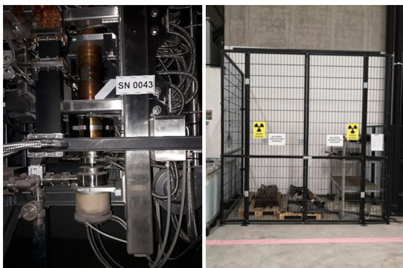
Slika 18: Linearni pospeševalnik delcev (levo), shramba z aktivirano opremo, ki je nastala pri obratovanju pospeševalnikov in je bila zamenjana (desno) (foto: ZVD, d. o. o., in STERIS, d. o. o.).
