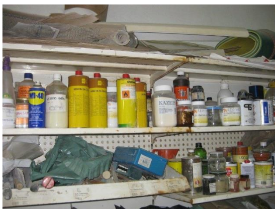
Slika 8: Neustrezno shranjevanje nevarnih snovi.
