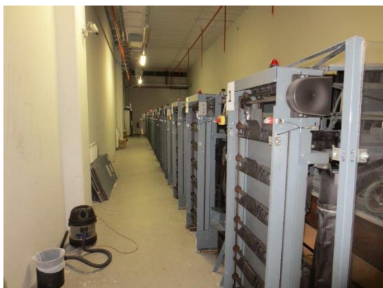
Slika 6: Možnost posega v notranjost stroja, ker ni nameščenih varoval.
