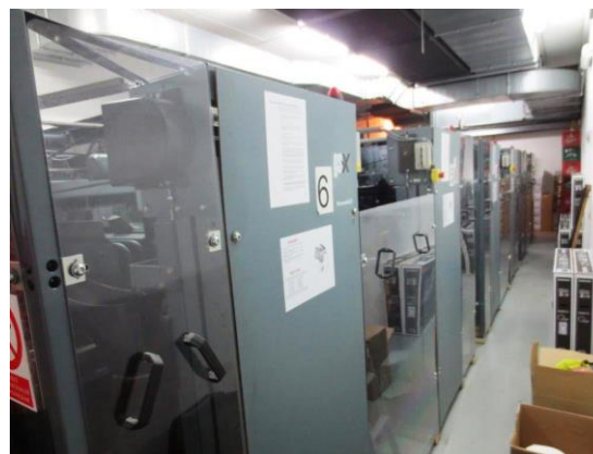
Slika 7: Ustrezno nameščena varovala preprečujejo poseg v notranjost stroja.
