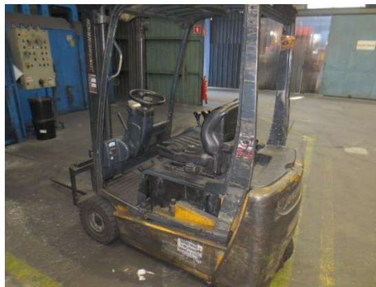
Slika 5: Slabo vzdrževana in neustrezna delovna oprema.
